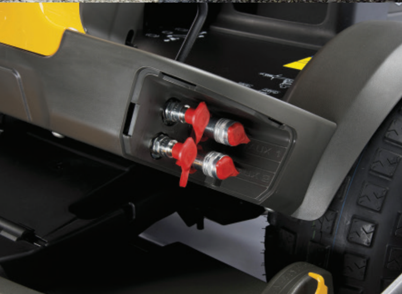
Hydro-link gør det muligt at betjene redskaberne hydraulisk fra førersædet (Park Pro 740 IOX).
