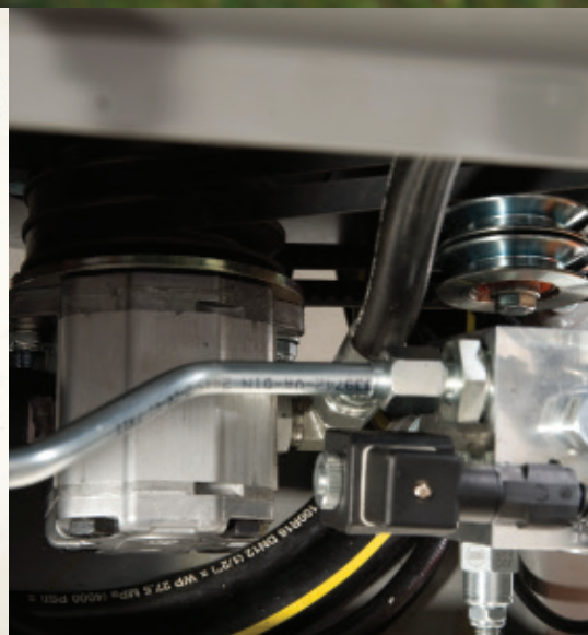
Hydrauliske rør (erstatte slanger) for at forlænge levetiden og mindske vedligeholdelse.
