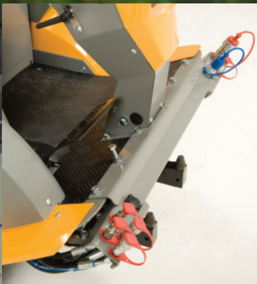
De hydrauliske udtag er placeret ergonomisk rigtigt.
