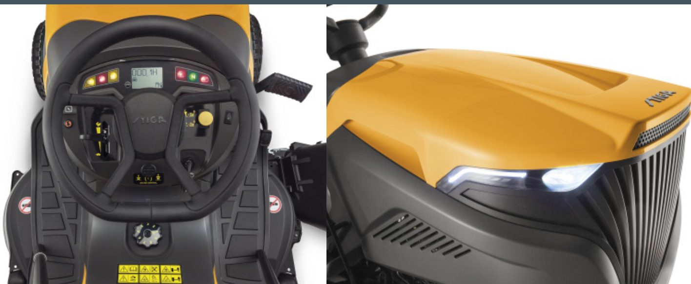
Instrumentbræt med multifunktionelt display giver mulighed for at holde øje med maskinens forskellige indstillinger og parametre.
