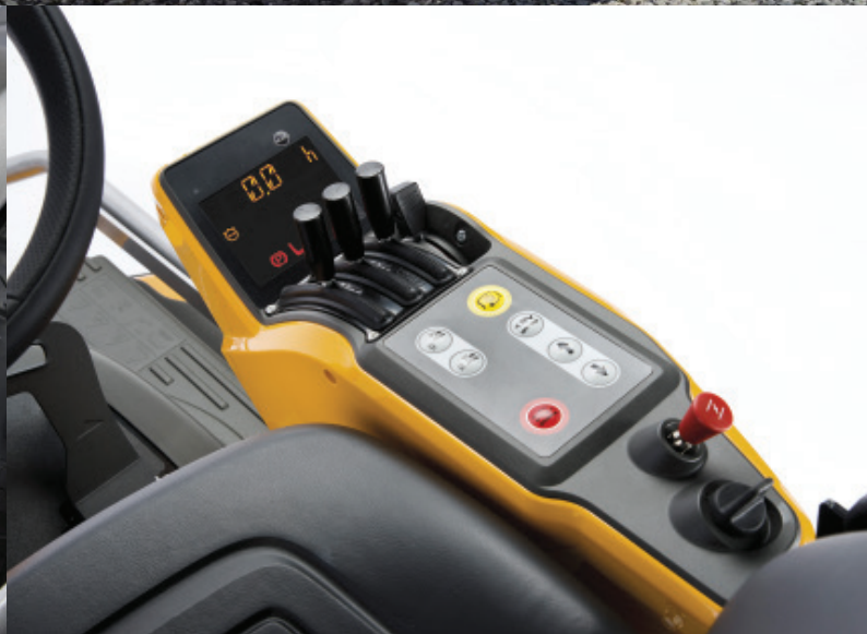
LED-infodisplay – meget intuitivt under alle vejrforhold. Føreren bliver under kørslen informeret om alle maskinens arbejdsparametre.
