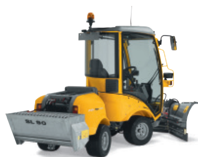
Sand- og grusudlægger SL90
